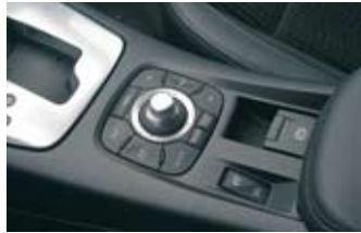
▲ Lagunan navigaattorin ja ajotietokoneen käyttö sujuu kätevästi etuistuinten välissä olevalla joystickin pätkällä. Karttaohjelma on yllättävänkin havainnollinen.
