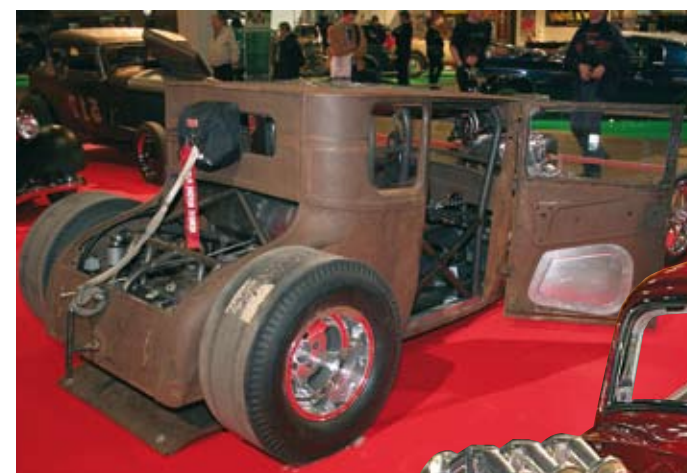
► David Bennetin omistaman Ford 5 Window Coupén (vm -33) konehuoneeseen on vaihdettu Cadillacin 331 V8.
