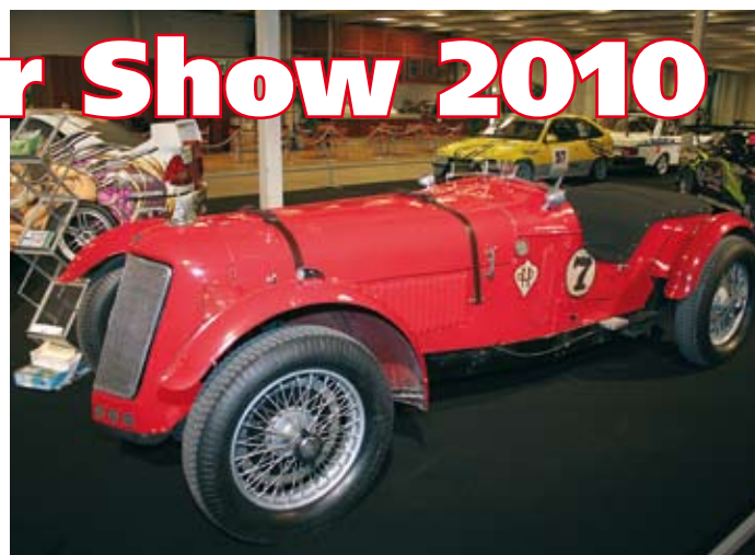
▲ Alvis Barson Special on rakennettu kilpa-autoksi vuonna 1937, menoa säätelee suora 8-sylinterinen moottori.
