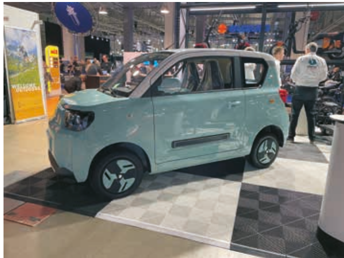
▲ Kontio Motors esitteli messuilla täys-sähköisen L7-ajoneuvoluokan (raskas nelipyörä) ajoneuvonsa. LT:n huippunopeus on 90 km/h ja range 170 km.
