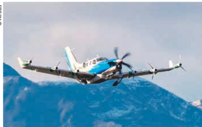
► Airbusin Ecopulse liitelee yhden polttomootorin ja kuuden sähkömootorin avulla.
