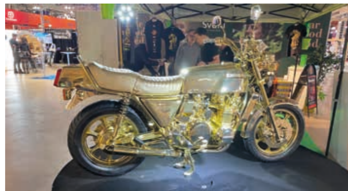
◀ Kawasaki KZ 1300 24K Gold Edition. Pyörän metalliosat ovat kellosepän tarkasti käsin kiillotettu ja elektronisesti pinnoitettu aidolla 24 K kullalla.
