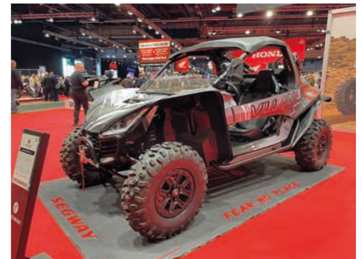
▼ Segway Villain SX10 X:ssä on 1000 cc, 4-tahtinen 2-sylinterinen DOHC, tehoa 105 hv ja vääntöä 93,5 Nm. Kytettävä neliveto. Suositushinta 19 990 €.
