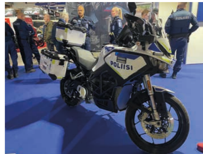
▲ Suomen poliisin ensimmäinen sähkömoottoripyörä Zero DSR X, tehoa 100 hv, vääntöä 225 Nm, huippunopeus 180 km/h.
