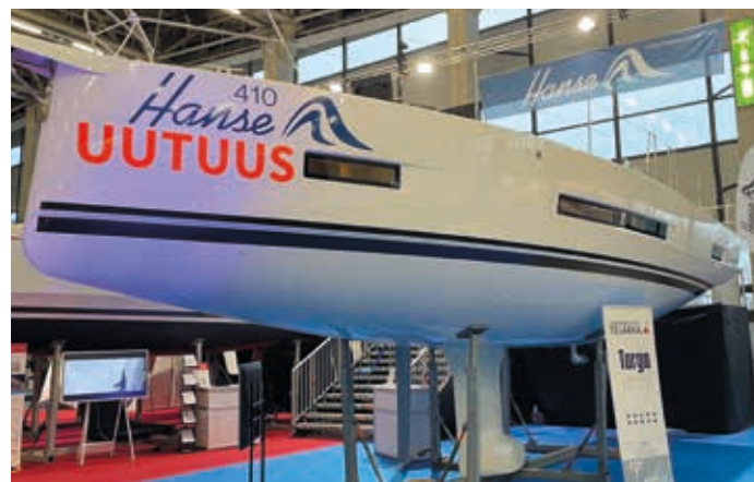
▲ ▼ Hanse 410 oli Hansailin messu-uutuus. Kokonaispituus 12,55 m, leveys 4,29 m, syväys 2,10 m ja paino 9,68 tn. Maston korkeus vesilinjasta 19,99 m.
