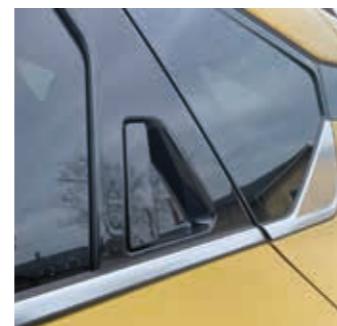
▲ Takaoven kahva on "piilotettu" C-pilariin.
