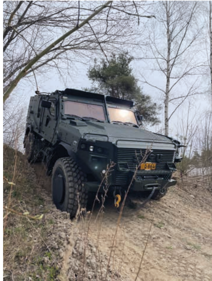
▼ GTP ei pelästy ensimmäistä kannokkoa, sillä 40 asteen lähestymis- ja jättökulmat mahdollistavat nousun jopa 60 asteen vastanäkeen.
